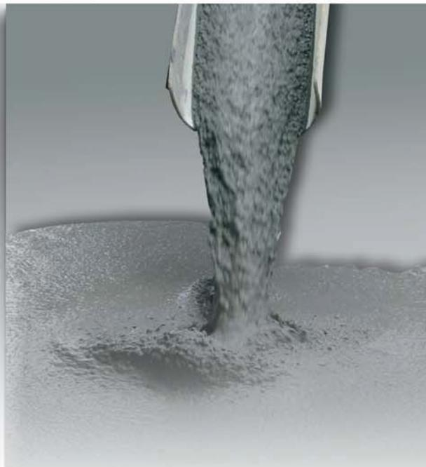
9 ans déjà que le Synad abordait le sujet des Bétons Auto-plaçants ! Dans leur sillage, les bétons courants ont vu également évoluer leur fluidité pour une plus grande rapidité et facilité de mise en œuvre.
